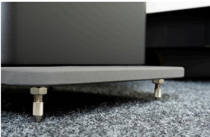
Die Bodenplatte überragt den Sockel vorderseitig. Dadurch können die Spikes, über die die M2 Kontakt mit dem Untergrund hat, weiter voneinander entfernt platziert werden, was die Standsicherheit erhöht. Die Metalldorne sind eingeschraubt und damit höhenverstellbar. So kann der Lautsprecher kippelfrei und absolut waagrecht aufgestellt werden. Ist das erreicht, dreht man die Kontermuttern der Spikes fest.
