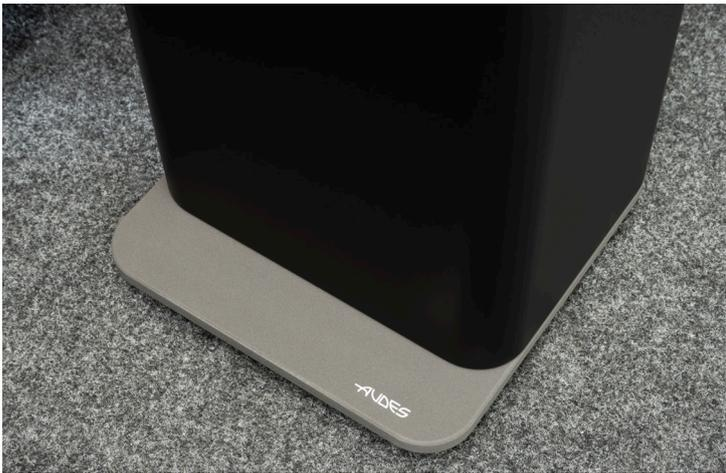
Die Bodenplatte ist mit einem matten Nextel-Lack überzogen. Darunter steckt das gleiche „Solid Surface“-Material, aus dem auch der Korpus des Monitors besteht. Der Sockel ist hingegen in MDF realisiert. Dieser Sandwich-artigen Materialfolge spricht Audez eine akustisch dämpfende Wirkung zu. So hat der scheinbar rein ästhetisch begründete Sockel auch eine akustische Wirkung.
