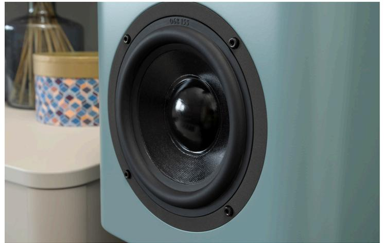
Der Mitteltiefenwoofer ist ein von Audez entwickelter 6,5-Zoll-Woofer. Er schallwandelt mit einer Papiermembran, die mit einer Spezialbeschichtung versehen ist. Derart versteift und zusätzlich unterstützt von der Bassreflexabstimmung sorgt er für tiefe Mitten und Bässe bis 55 Hertz.
