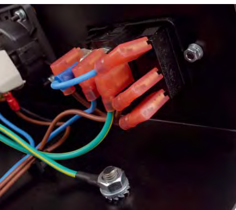
VDE-konforme Verdrahtung, zumindest der Gehäuseboden ist mit dem Schutzleiter verbunden
