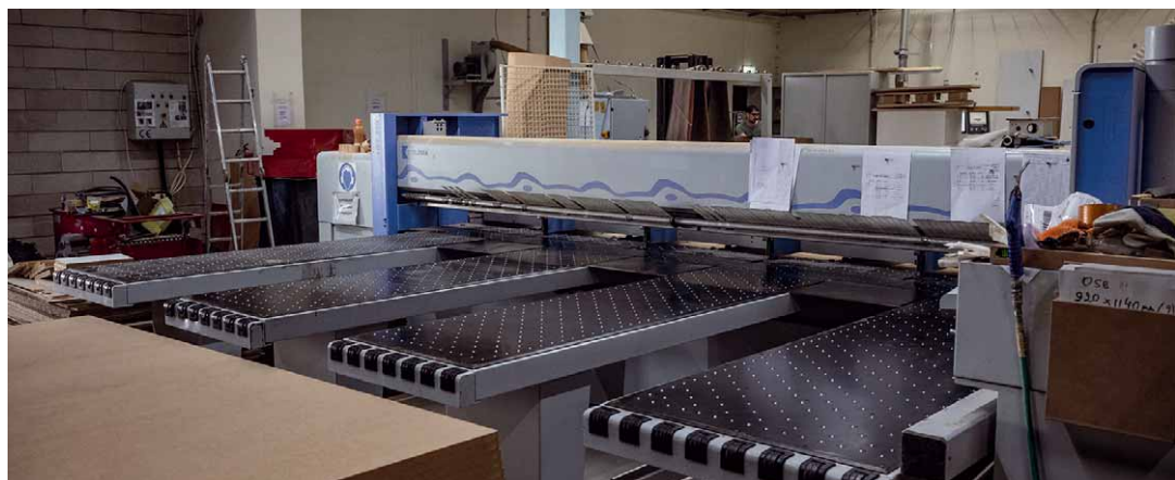
Auf diesem Formatierautomaten werden große Platten zerteilt, bevor sie auf eine der CNC-Fräsen kommen
