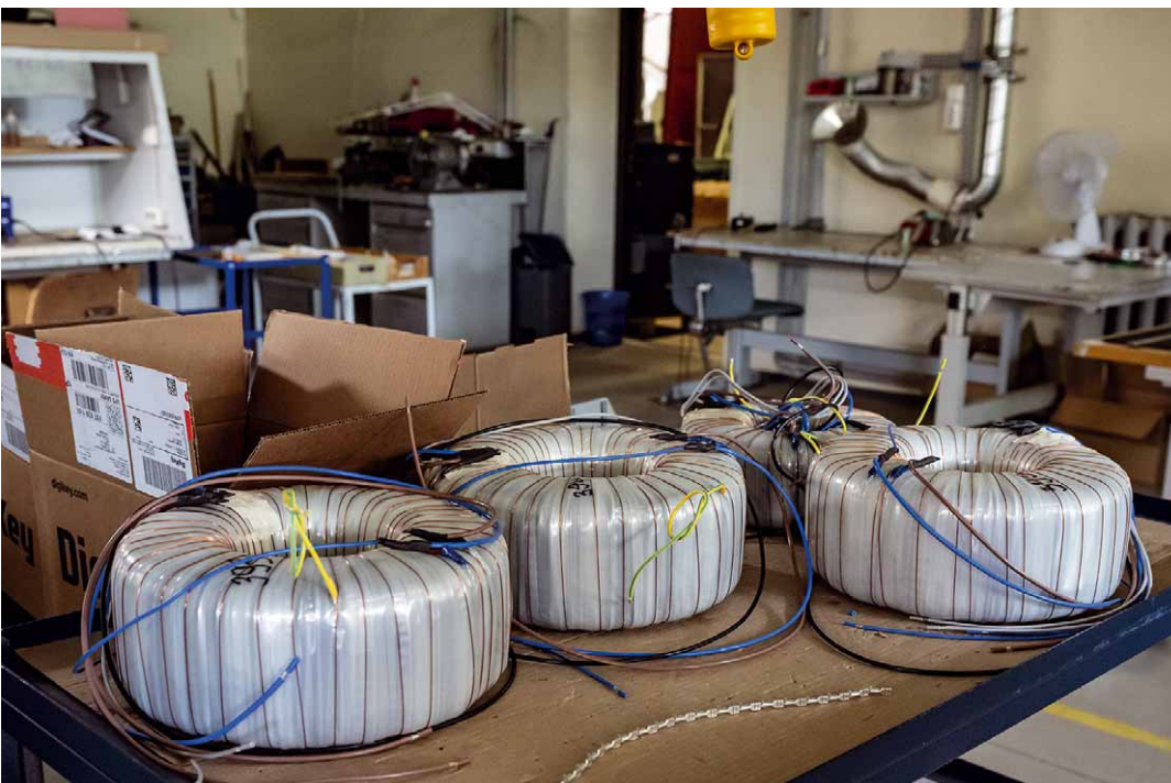
Ein paar größere Ringkerntransformatoren vor dem Verguss
